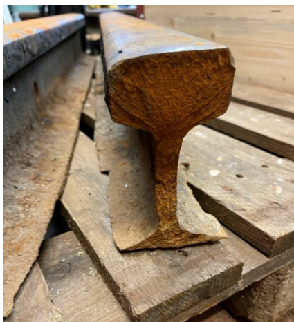
Figure 11-1: corrosion au niveau du patin du rail
